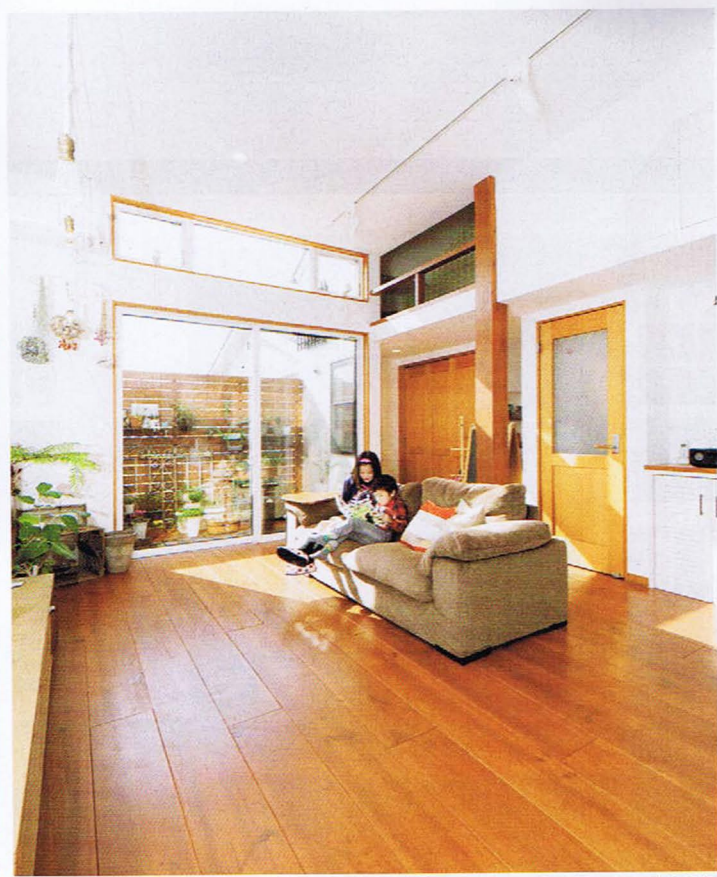
床材はパインの無垢材を自然塗料で仕上げ、壁は珪藻土。アンティークなインテリアが好きなSさんにぴったりの空間ができあがった。外からは想像もできないほど明るい室内が実現
